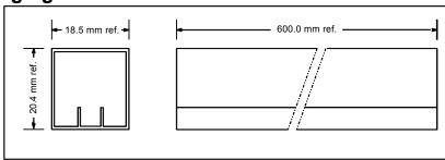
40 relays per tube, 30 tubes per box (1200 relays per box)
